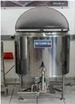
OBJECTIF: réservoir où le mélange de crème glacée est stocké après en passant à travers l'échangeur de chaleur à plaques multiples. Capacité: 300 litres.
