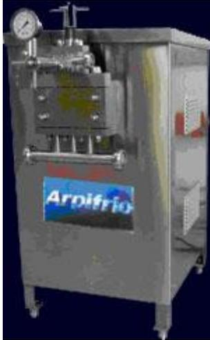
Equipement destiné à homogénéiser le mélange à la plus petite taille des particules que possible, en fournissant la meilleure qualité et l'incorporation d'air dans le mélange final.
