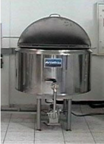
OBJECTIF: réservoir où les ingrédients de la crème glacée sont mélangés et chauffés. Capacité: 300 litres.
